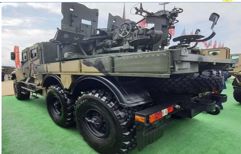
Рисунок 9 – Модернизированная зенитная пушка С-60 на базе броневика «Спартак»
