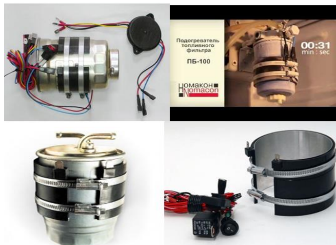
Рисунок 3 – Подогреватель фильтра тонкой очистки топлива накладной бандажный
