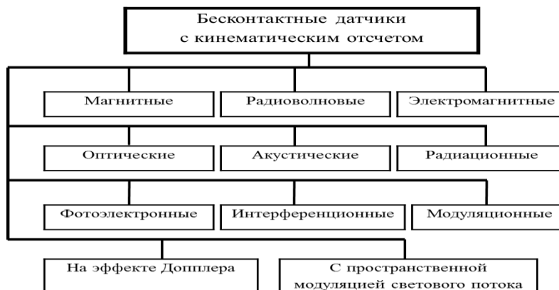
Рисунок 1 – Классификации датчиков относительной вибрации (с кинематическим отчетом)
