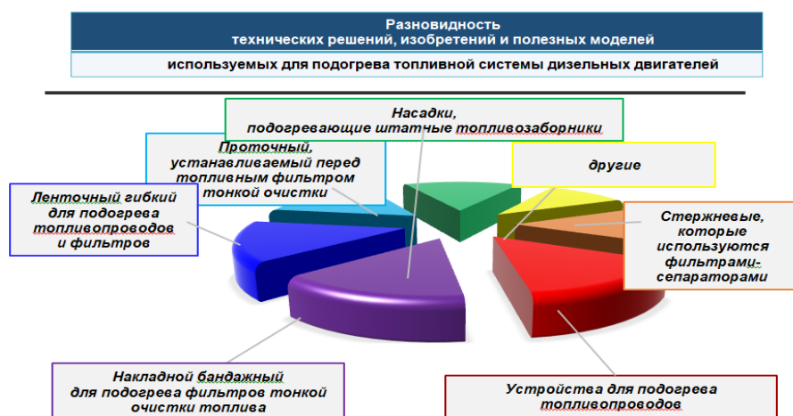
Рисунок 1 – Технические решения, изобретения и полезные модели используемые для подогрева топливной системы дизельных двигателей
